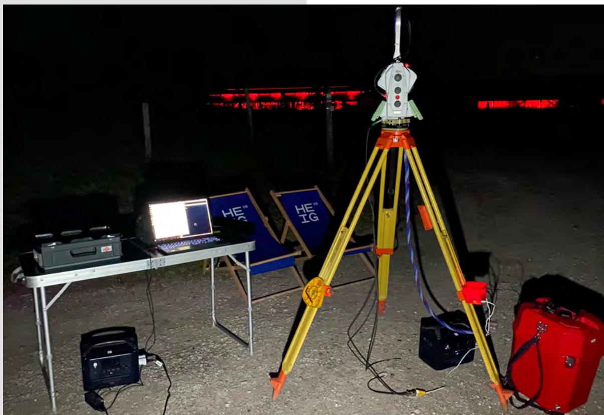
Figure 2 – PyDaedalus lors de la détermination d'un profil astro-géodésique au CERN
