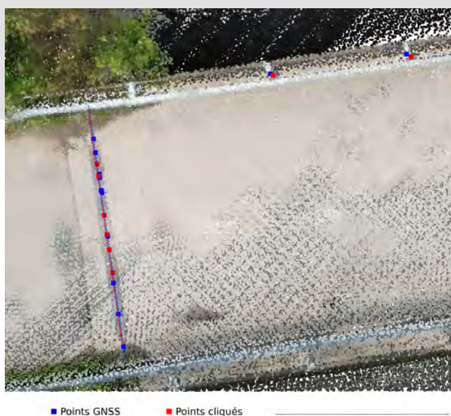
Figure 5 – Vue ortho de la partie Est du pont au dessus de la Sarine, (bleu) points mesuré au gnss, (rouge) points cliqués sur le nuage de points
