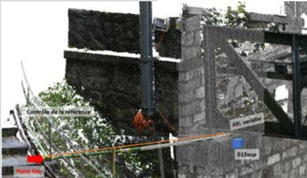
Figure 2 – Utilisation d’une chaîne inclinométrique pour suivre les variations altimétriques proches du capteur 01Sup
