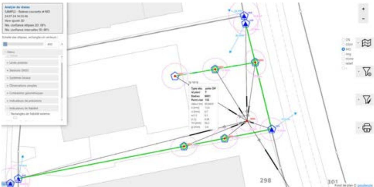
Figure 5 – Interface de ResMap pour visualiser les réseaux et les résultats de l'ajustement
