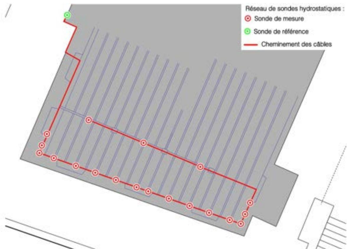
Figure 4 – Plan d'installation du système de nivellement hydrostatique
